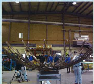
「イザナギ」アンテナの製作中の様子。(提供: QPS研究所)
